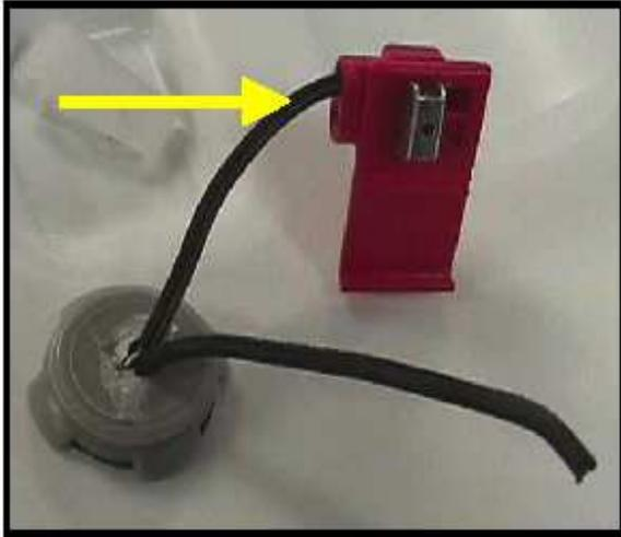
4. Entonces inserte uno de los cables del sensor en el conector.
