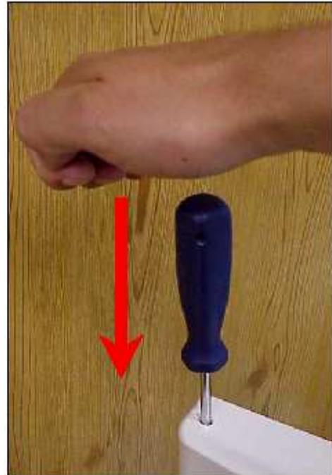
7) Instale el buje de parada izquierdo y conecte en el lado izquierdo (abajo del cobertor de la puerta del refrigerador) de manera ordenada.
