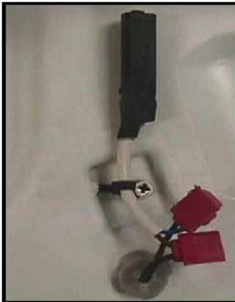
NOTA: El sensor debe estar dirigido hacia arriba. No deje que el sensor raspe o pegue contra la hélice del forzador.
