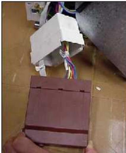
2 – Con un tester colocado en la escala de medición de voltaje de corriente continua (Vcc), realice la lectura de voltaje del sensor en los cables marrón y azul (primeros de la izquierda) de la ficha conectada en el módulo de potencia.
